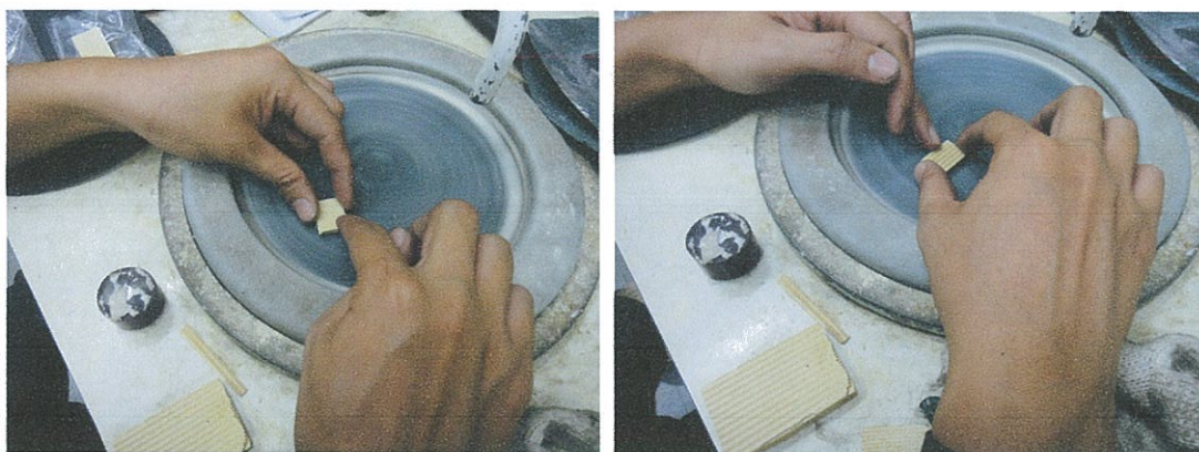
รูปที่ 3.21 การเตรียมชิ้นงานของตัวกรองละอองธูดีเซล(ซ้าย) ที่มีสารเร่งปฏิกิริยาเคมี และ (ขวา) ตัวกรองละอองธูดีเซลไม่มีสารเร่งปฏิกิริยาเคมี
