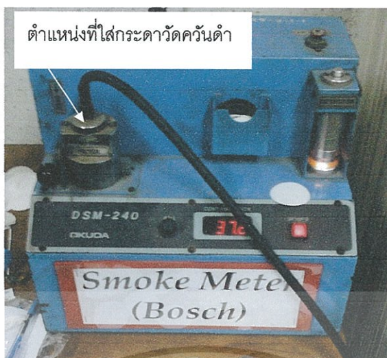
รูปที่ 3.43 เครื่องวัดควันดำของกระดาษกรองที่นำมาใช้วัดค่าประสิทธิภาพการกรอง
