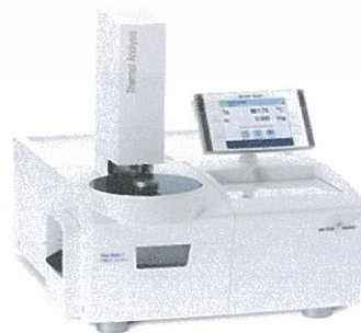
รูปที่ 2.31 เครื่องมือวิเคราะห์ด้วยวิธีชั่งน้ำหนักเชิงความร้อน [29]
