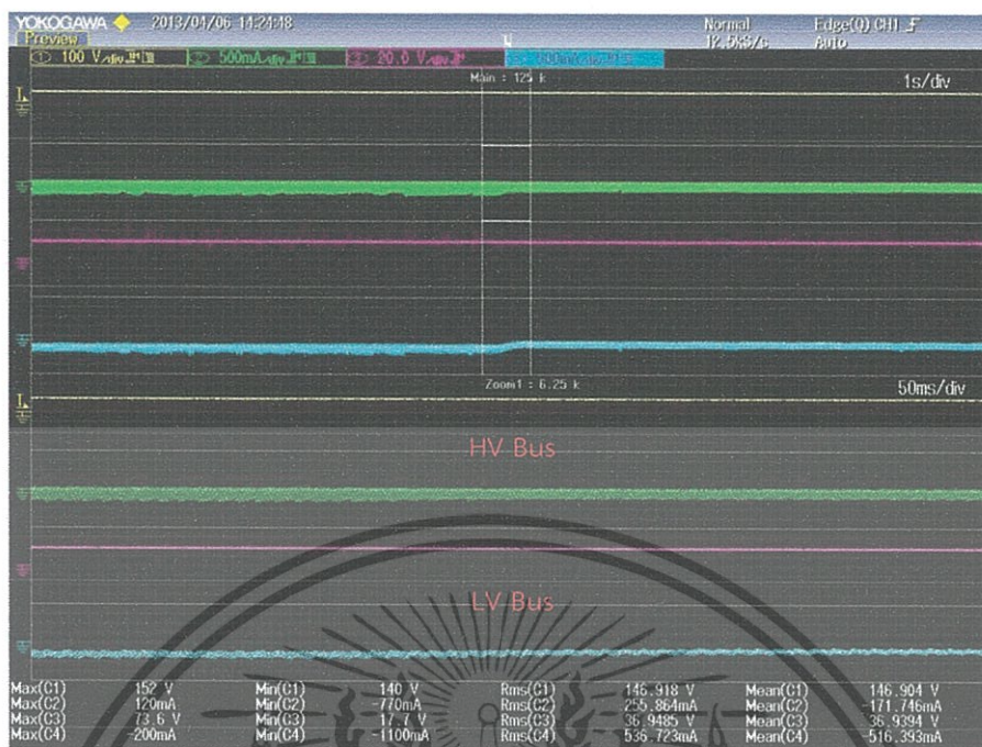
รูปที่ 6.25 แรงดันและกระแสไฟฟ้าที่ชดวจร M^2C^3 ที่ 2
