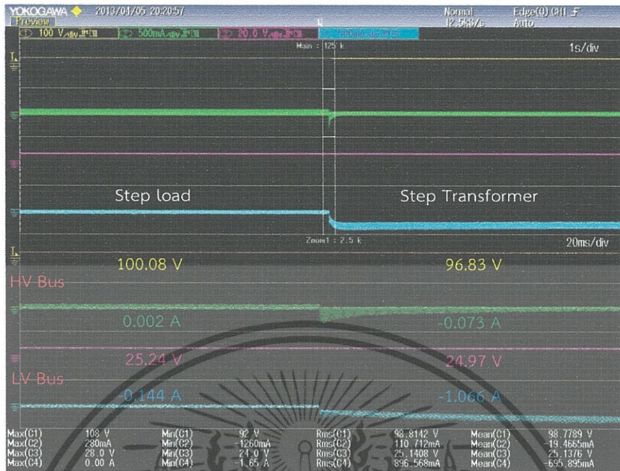
รูปที่ 6.61 แรงดันและกระแสไฟฟ้าที่ชุดวงจร M 2 C 3 ที่ 2
