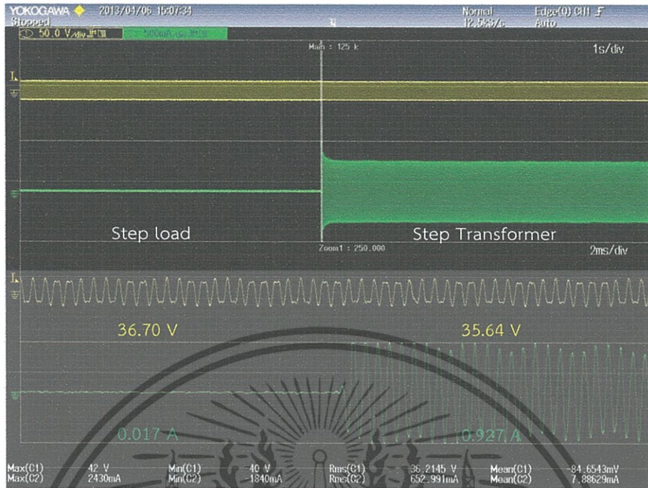
รูปที่ 6.35 แรงดันและกระแสไฟฟ้าที่หม้อแปลงความถี่สูง
