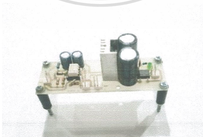
รูปที่ 5.4 อุปกรณ์ไฟเลี้ยงและขับสัญญาณ
