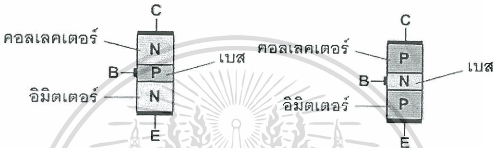
ภาพที่ 2.19 โครงสร้างและชนิดของทรานซิสเตอร์
