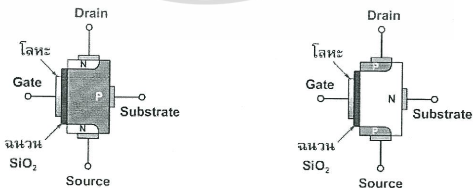
ภาพที่ 2.48 โครงสร้างของอีมอสเฟต
