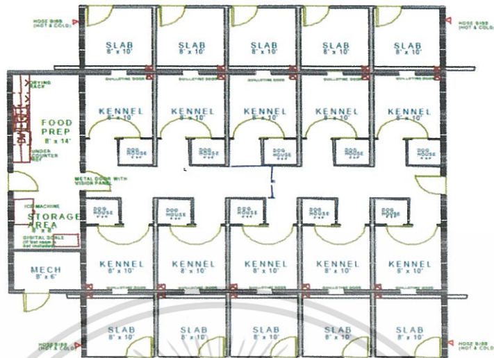
รูปที่ 4.2 ตัวอย่างการออกแบบผังพื้นคอกสัตว์ และทัศนียภาพภายใน
