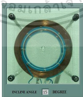
รูปที่ 4.17 การแสดงผลการวัดค่ามุมเอียงของเพลานในแกนตั้งในระนาบ XY แบบมี
