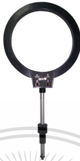
รูปที่ 3.1 โครงสร้างของขดลวดเฮลมโฮลทซ์ของบริษัท LEYBOLD DIDACTIC GMBH
