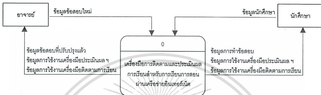
รูปที่ 3.1 DFD ระดับ Context Diagram ของเครื่องมือการติดตามและประเมินผล การเรียน สำหรับการเรียนการสอนผ่านเครือข่ายอินเทอร์เน็ต
