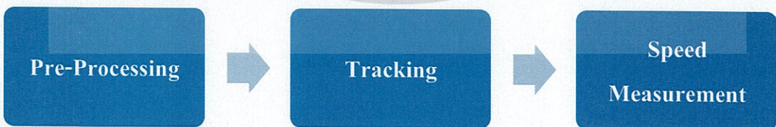
รูปที่ 2.3 กระบวนการตรวจวัดความเร็วด้วยการประมวลผลภาพ
