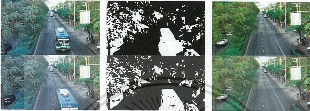
รูปที่ 3.5 ผลการแยกวัตถุออกจากพื้นหลังของอัลกอริทึม Static Frame Difference
