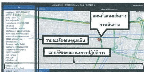
รูปที่ 6. หน้าจอแท็บเล็ตสำหรับรถบริการการแพทย์ฉุกเฉินแสดงแผนที่การเดินทางและรายละเอียดคำสั่งปฏิบัติการ
