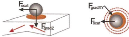
รูปที่ 2.7 ส่วนประกอบของแนวแรงที่กระทำต่ออนุภาคในบริเวณใกล้เคียงกับโครงสร้างโลหะแบบแผ่นงาน [18]
