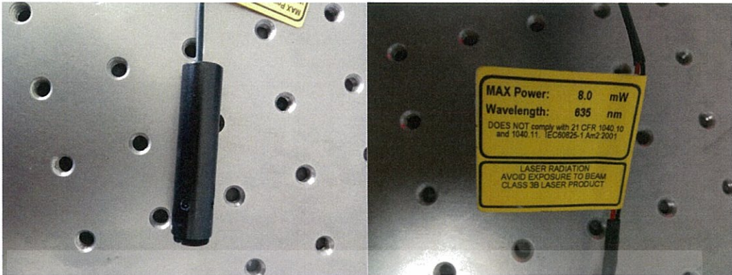
รูปที่ 3.13 (ซ้าย) ภาพเลเซอร์ไดโอดด้านข้าง , (ขวา) คุณสมบัติของเลเซอร์ไดโอด
