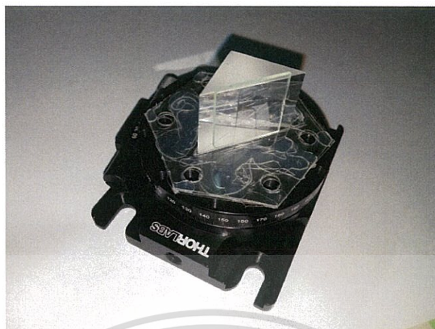
รูปที่ 3.17 ลักษณะของ Rotatable Prism holder และ BK7 Prism
