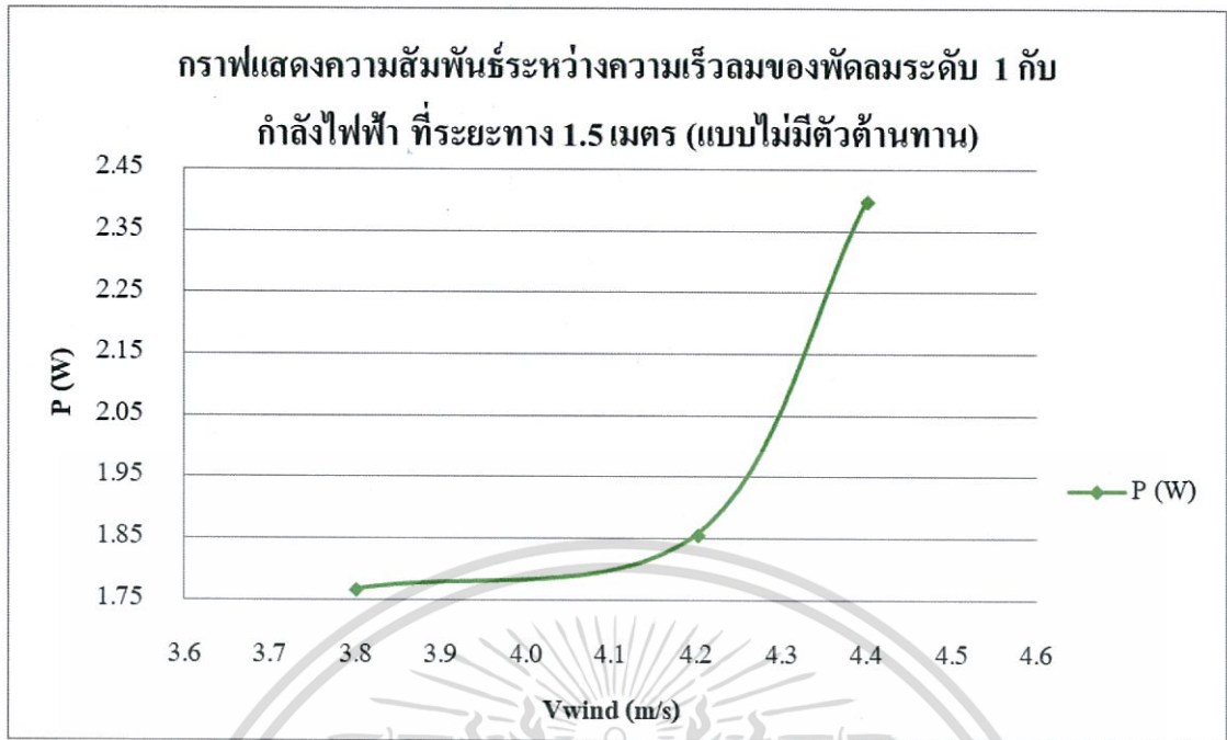
รูปที่ 4.17 กราฟแสดงความสัมพันธ์ระหว่างความเร็วลมของพัดลมระดับ 1 กับกำลังไฟฟ้า ที่ระยะทาง 1.5 เมตร (แบบไม่มีตัวต้านทาน)
