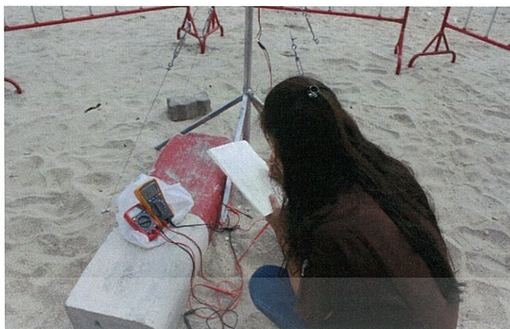
รูปที่ 4.65 แสดงการวัดค่ากระแสและแรงดันที่ได้จากกังหันลม
