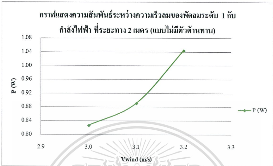
รูปที่ 4.20 กราฟแสดงความสัมพันธ์ระหว่างความเร็วลมของพัดลมระดับ 1 กับกำลังไฟฟ้า ที่ระยะทาง 2 เมตร (แบบไม่มีตัวต้านทาน)
