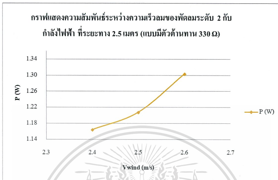
รูปที่ 4.49 กราฟแสดงความสัมพันธ์ระหว่างความเร็วลมของพัดลมระดับ 2 กับกำลังไฟฟ้า ที่ระยะทาง 2.5 เมตร (แบบมีตัวต้านทาน 330 \Omega )
