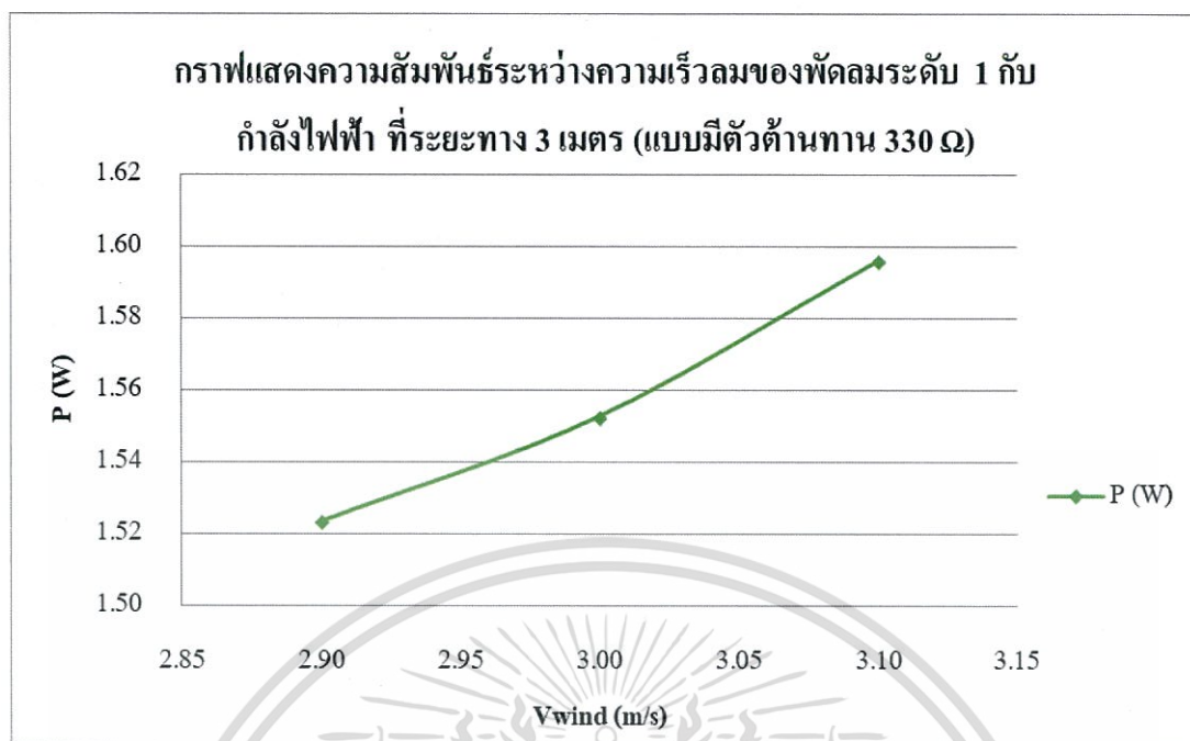
รูปที่ 4.53 กราฟแสดงความสัมพันธ์ระหว่างความเร็วลมของพัดลมระดับ 1 กับกำลังไฟฟ้า ที่ระยะทาง 3 เมตร (แบบมีตัวต้านทาน 330 Ω)
