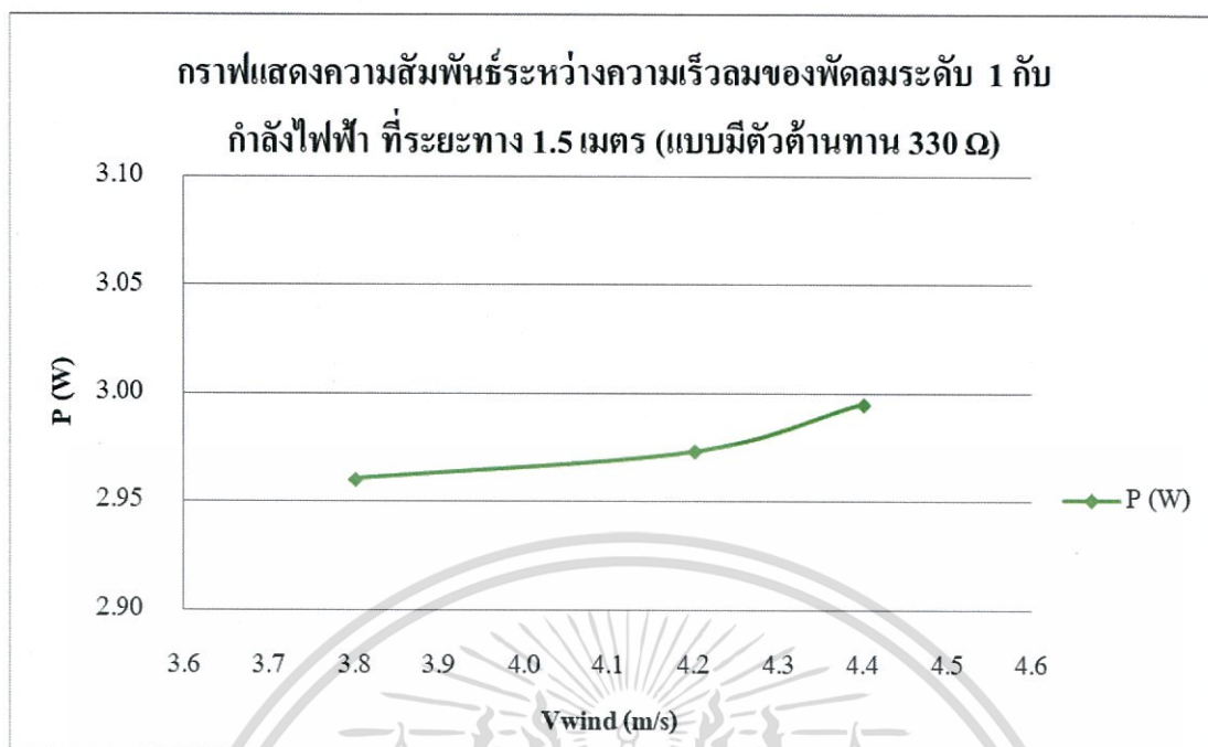
รูปที่ 4.44 กราฟแสดงความสัมพันธ์ระหว่างความเร็วลมของพัดลมระดับ 1 กับกำลังไฟฟ้า ที่ระยะทาง 1.5 เมตร (แบบมีตัวต้านทาน 330 \Omega )
