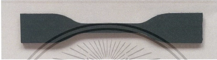
รูปที่ 3.3 ชิ้นงานตัวอย่างสำหรับการทดสอบแรงดึง
