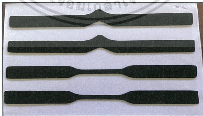
รูปที่ 3.4 ชิ้นงานเป็นรูปดัมเบลล์และรูปปีกนก
