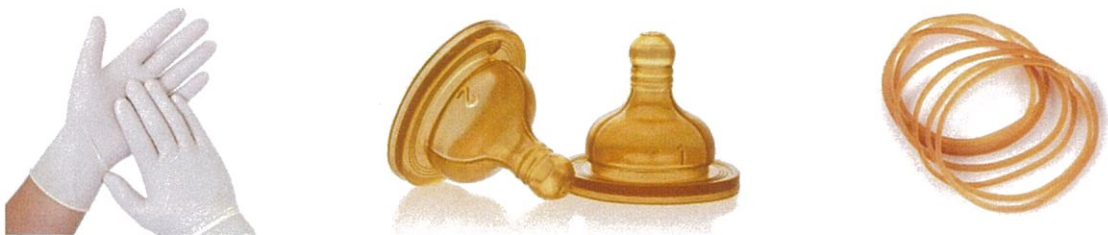
รูปที่ 2.14 ตัวอย่างวัตถุดิบที่ใช้ในการผลิตยางรีเคลม [28-30]
