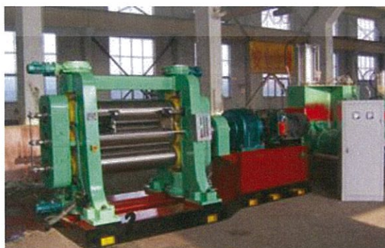
รูปที่ 2.40 เครื่องคาลเ็นเดอร์ (Calender) [49]
