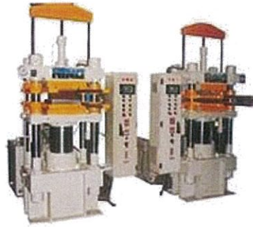
รูปที่ 2.37 เครื่องจักรแม่พิมพ์แบบกึ่งฉีด [49]
