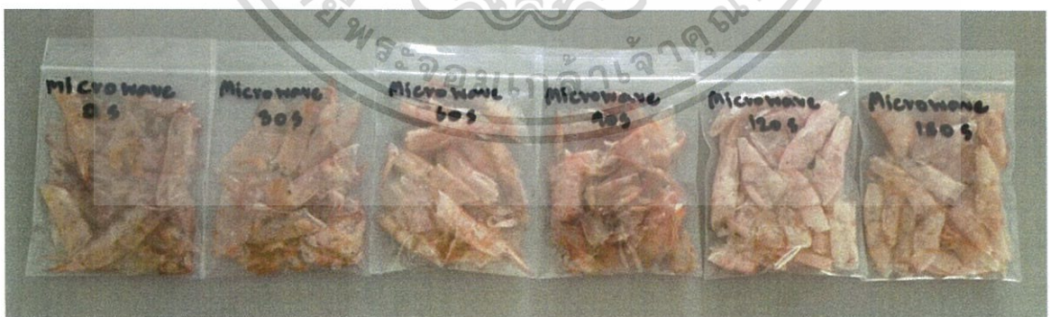
ภาพที่ 4.6 เปลือกกุ้งขาวที่ผ่านการอบแห้งโดยใช้เตาอบไมโครเวฟโดยใช้กำลังไฟฟ้า 700 วัตต์
