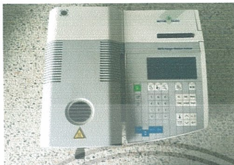
ภาพภาคผนวก ค.4 เครื่องวัดปริมาณความชื้น (Halogen Moisture Analyzer)
