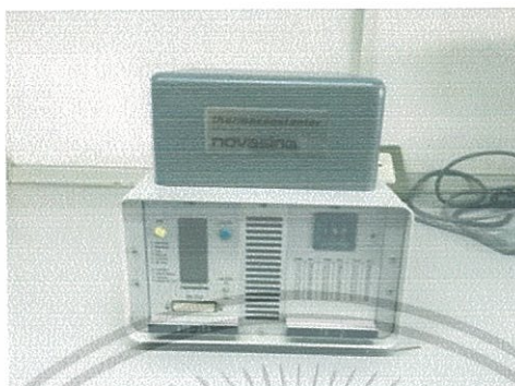
ภาพภาคผนวก ค.5 เครื่องวัดค่ากิจกรรมน้ำ (Water activity meter)
