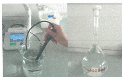
ภาพที่ ก.3 การเตรียม 0.05 โมลาร์ Phosphate buffer pH 6.2
