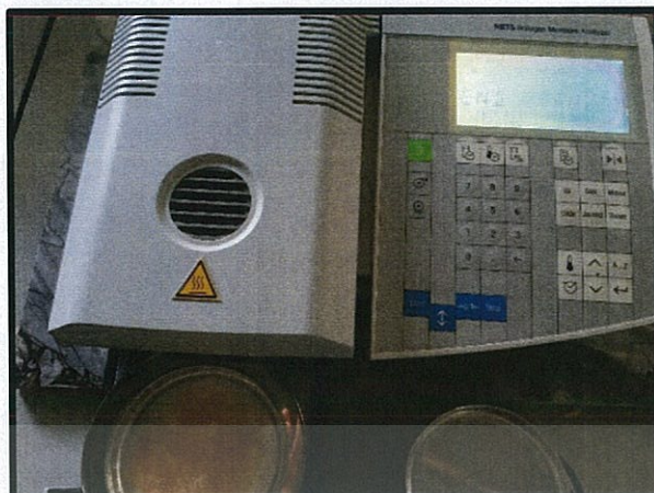
ภาพที่ ก.3 เครื่อง Halogen Moisture analyzer รุ่น HR-73
