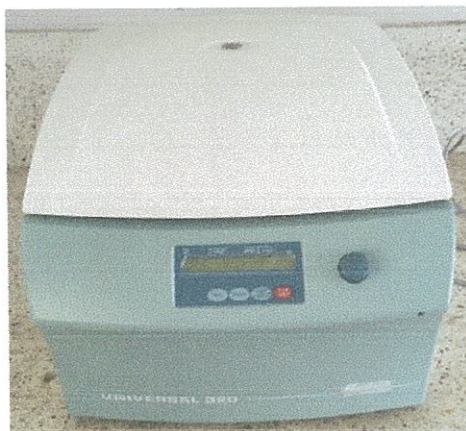
ภาพที่ ข.7 เครื่องปั่นเหวี่ยง (Centrifuge)
