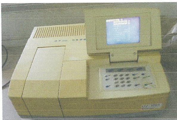
ภาพที่ ข.6 เครื่องวัดค่าการดูดกลืนแสง (UV-Vis spectrophotometer: UV-1601)
