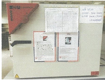
ภาพที่ ข.6 ตู้อบไฟฟ้า (Hot air oven)
