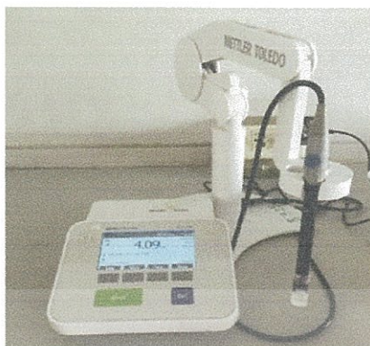
ภาพที่ ข.4 เครื่องวัดค่าความเป็นกรด-ด่าง (pH meter)
