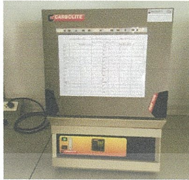
ภาพที่ ข.7 เตาเผาไฟฟ้า (Muffle furnace)
