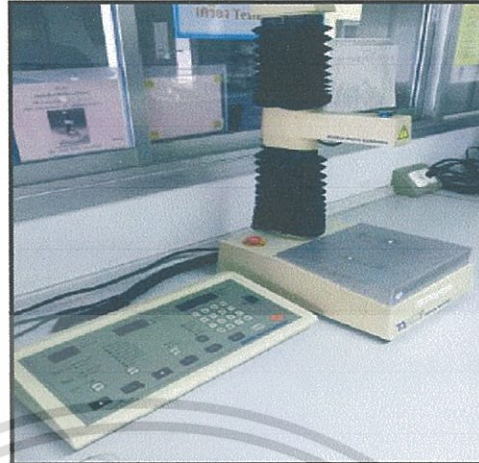
ภาพที่ ข.6 เครื่อง Texture Analyzer รุ่น TA-XT2
