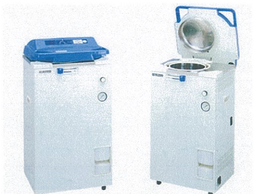
ภาพที่ ง.10 นำเขียวหวานไก่สเปรด สูตรลดพลังงานไปผ่านกระบวนการฆ่าเชื้อด้วย ความร้อนที่อุณหภูมิ 121°C, 20 นาที
