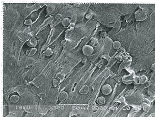
รูปที่ 2.1 ลักษณะของแกรนูลแป้งที่ใช้เป็นสารตัวเติมหรือ Filler ซึ่งกระจายตัวอยู่ในเนื้อพลาสติก [2]
