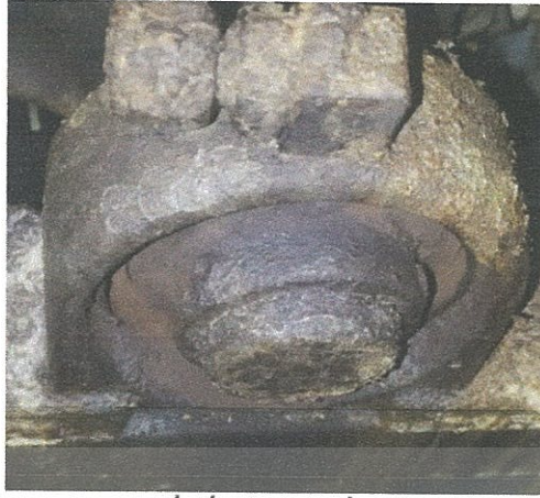
ภาพที่ 4.7 แสดงเบริงที่มีสารเคมีสิ่งสกปรกเกาะอยู่โดยรอบ
