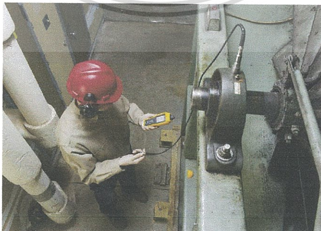
ภาพที่ 4.9 แสดงภาพตัวอย่างการวัดการสั่นสะเทือนที่แบริ่ง
