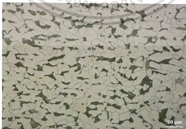
ภาพที่ 4.10 ภาพถ่ายลักษณะโครงสร้างจุลภาคที่ตำแหน่งกึ่งกลางของชิ้นงานปกติ
