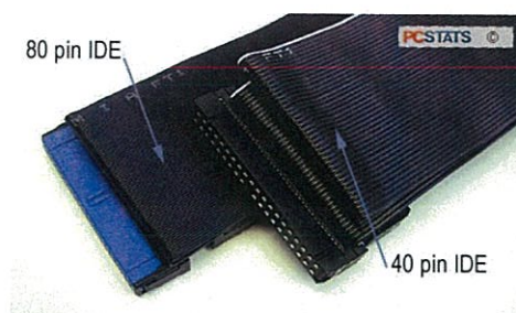
ภาพที่ 2.24 ความแตกต่างระหว่างอุปกรณ์เชื่อมต่อฮาร์ดดิสก์ไทรฟ์แบบ IDE และ E-IDE
