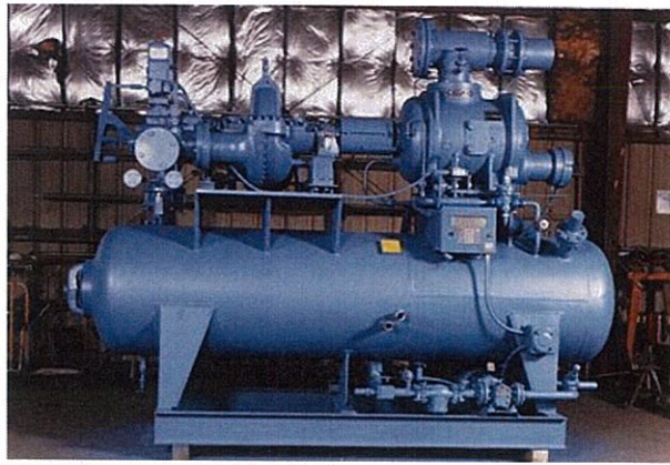
ภาพที่ 2.16 เครื่องอัดอากาศชนิดสกรู
