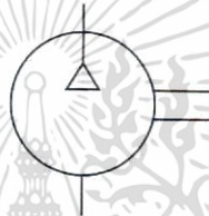
ภาพที่ 2.11 สัญลักษณ์ของเครื่องอัดอากาศ
