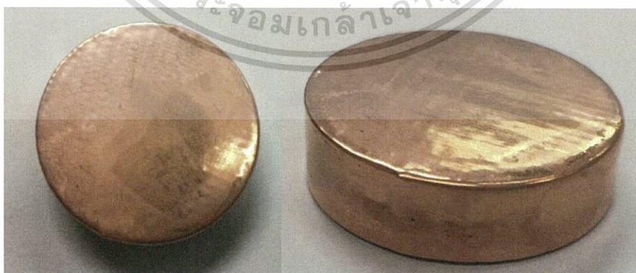
รูปที่ 4.7 ชิ้นงาน C ชุบด้วยโลหะทองแดง 5 นาที
