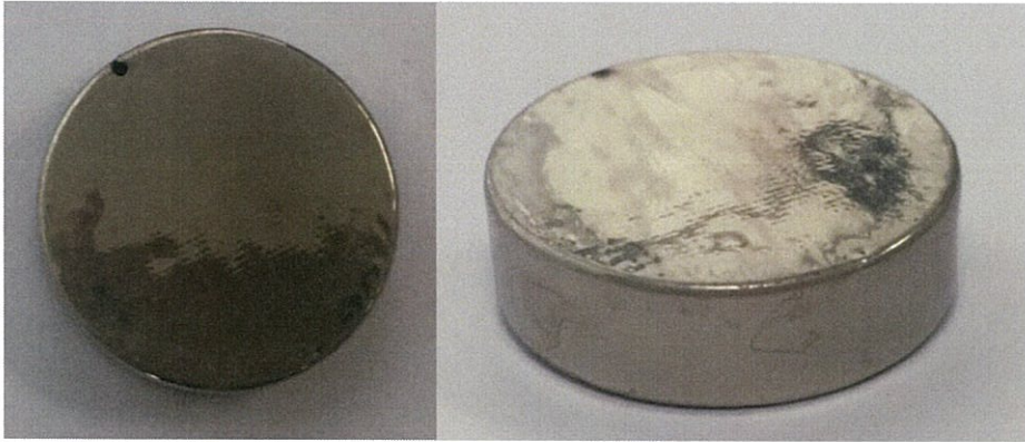
รูปที่ 4.8 ชิ้นงาน C ชุบด้วยโลหะนิกเกิล 40 นาที ที่อุณหภูมิ 50 องศาเซลเซียส
