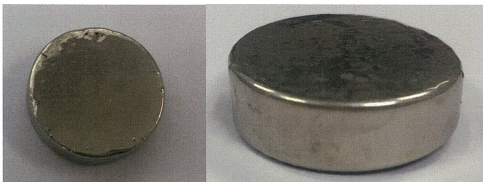
รูปที่ 4.5 ชิ้นงาน B ชุบด้วยโลหะนิกเกิล 30 นาที ที่อุณหภูมิ 50 องศาเซลเซียส
