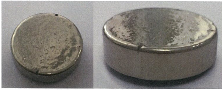
รูปที่ 4.2 ชิ้นงาน A ชุบด้วยโลหะนิกเกิล 20 นาที ที่อุณหภูมิ 50 องศาเซลเซียส
