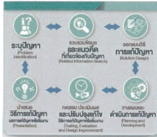
รูปที่ 2.1 องค์ประกอบกระบวนการออกแบบเชิงวิศวกรรม
