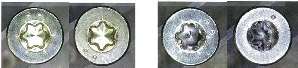
ภาพที่ 3.4 แสดงลักษณะของสกรูดี(ซ้าย)และเสีย(ขวา) จากการส่องผ่านกล้อง Microscope หลังการคัดแยกผ่านเครื่อง Screw sorting machine
