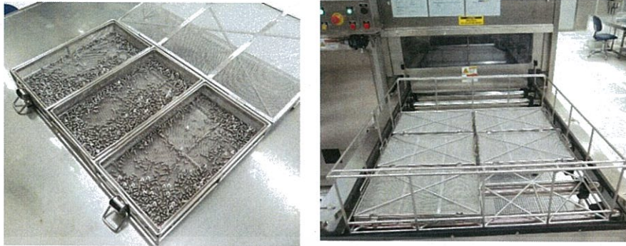
ภาพที่ 3.5 แสดงตะกร้าที่บรรจุสกรูและการไหลดสกรูเข้าเครื่องล้างตามลำดับ
