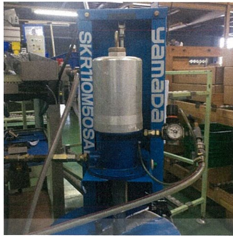
รูปที่ 4.10 หลังปรับเกจความดัน ทำให้ได้ปริมาณจาระบีมีค่าตรงตามมาตรฐานที่กำหนด
