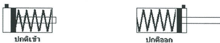
ภาพที่ 2.39 แสดงสัญลักษณ์ของกระบอกสูบทางเดียวแบบปกติเข้าและปกติออก
