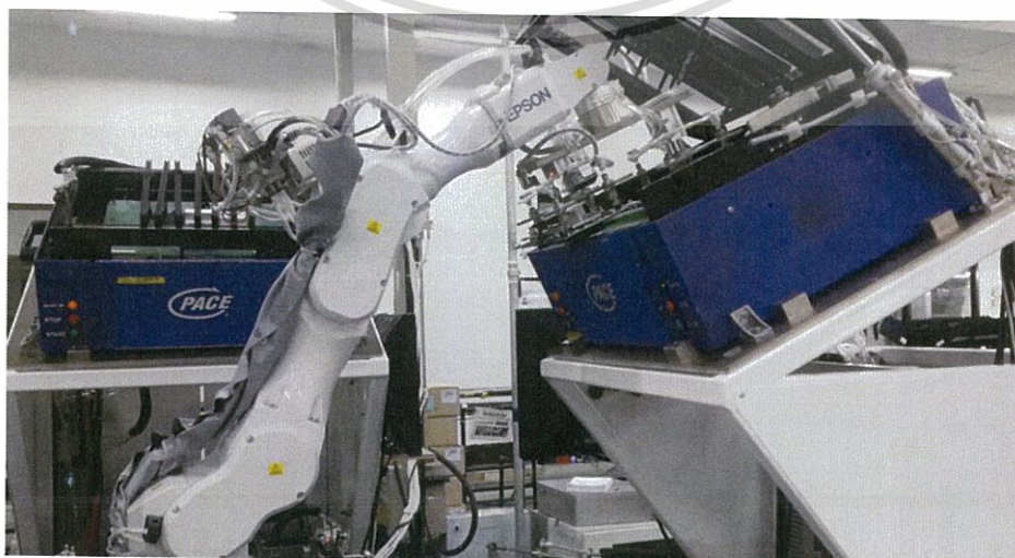
ภาพที่ 3.6 ขณะที่ Robot ทำงานร่วมกับ FCT Station
