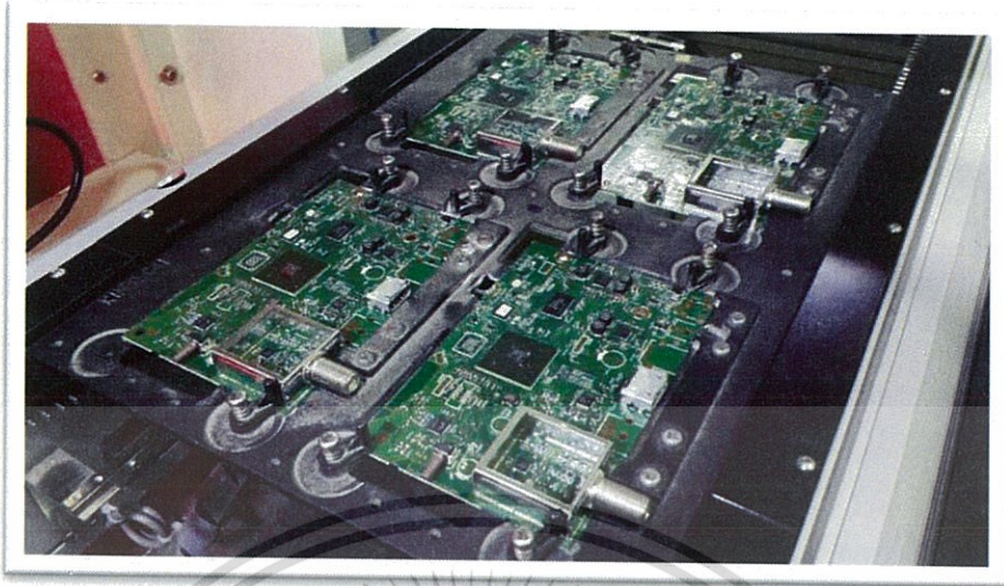
รูปที่ 4-1 แผงวงจรอิเล็กทรอนิกส์ (PCB) ที่ใช้ในการทำกล่องดาวเทียม
