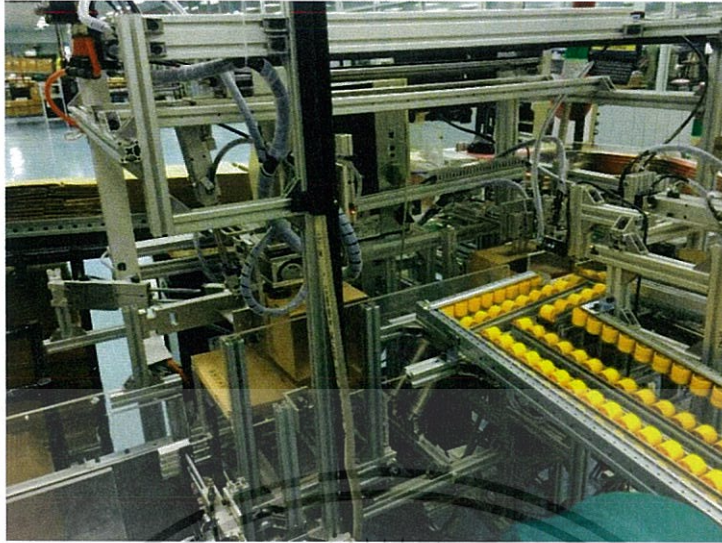
รูปที่ 3.33 แสดงการติดตั้ง Sensor ต่างๆ บนเครื่องอัตโนมัติ
