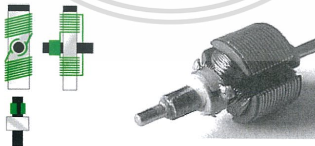
รูปที่ 2.88 แสดงโครงสร้างและภาพจริงของอาร์เมเจอร์
