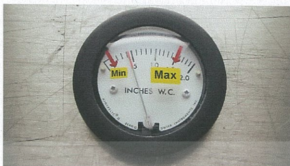
ภาพที่ 3.10 แสดง เกจวัดความดันแสดงความดันภายใน Chamber
