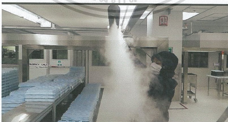
ภาพที่ 3.7 แสดง การใช้ Fogger เพื่อสังเกตพฤติกรรมการไหลของอากาศที่ออกมาจากลามินาร์
