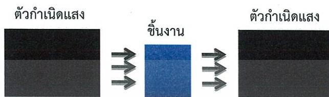
ภาพที่ 3.2 ภาพจำลองหลักการทำงานของเครื่อง Marposse
