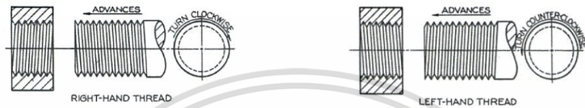
ภาพที่ 2.4 ลักษณะของเกลียวขวาและเกลียวซ้าย
