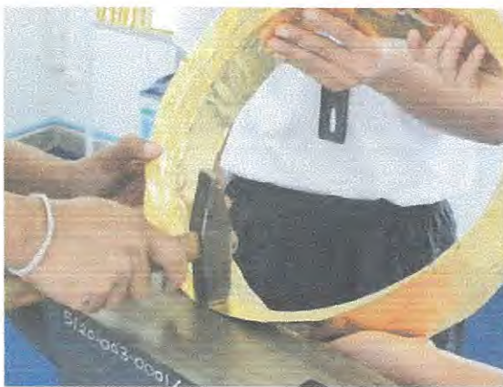
ภาพที่ 2.54 การใช้ค้อนเหล็กตีแผ่นเหล็ก ที่มา :ถ่ายโดย สำเนียง หนุคง 2556
