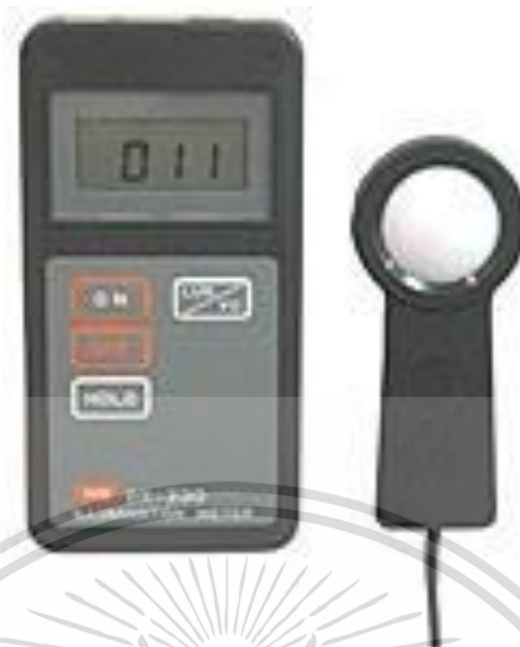
ภาพที่ 3.1 แสดงลักษณะอุปกรณ์ในการวัดแสง ลักซ์มิเตอร์
