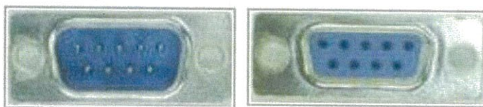
รูปที่ 2.19 แบบ DB9 ตัวผู้และพอร์ตอนุกรมของอุปกรณ์ภายนอก DB9 ตัวเมีย
