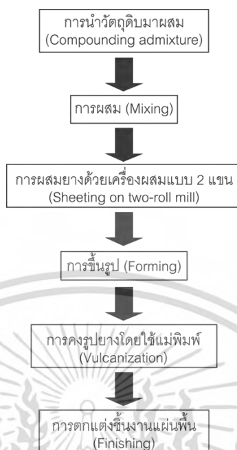
ภาพที่ 2.7 กระบวนการและขั้นตอนการสร้างแผ่นพื้น ที่มา: ศุภชัย แก้วจิ่ง (2552)
