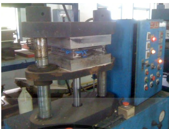
ภาพที่ 2.8 เครื่องกดอัดระบบไฮดรอลิก (Hydraulic machine) ที่มา: อารยา เอกปริญญา (2554)
