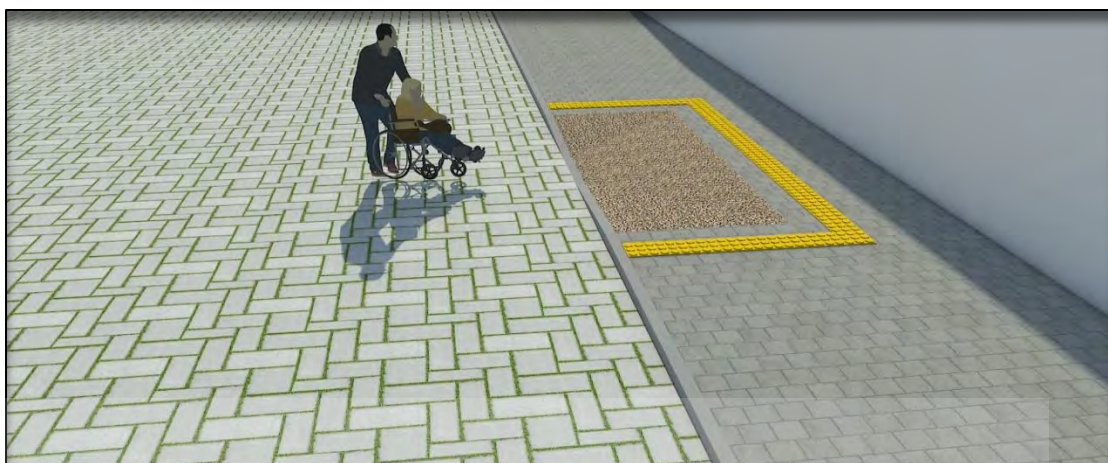
ภาพที่ 6.14 ตัวอย่างข้อเสนอแนะทางลาดการใช้บริการสำหรับผู้สูงอายุ คนพิการ ฯลฯ
