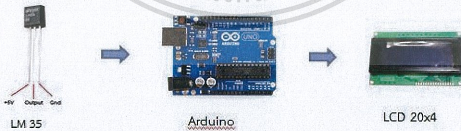
รูปที่ 3.8 ออกแบบการวัดอุณหภูมิ
