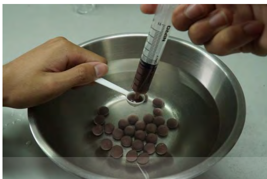
ภาพภาคผนวกที่ ค.9 การขึ้นรูปทรงกลมของของผสมระหว่างน้ำนมข้าว และสารละลายอัลจินเนตด้วยไซริงค์
