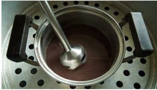
ภาพภาคผนวกที่ ค.3 การใช้เครื่องปั่นมือถือในการผสมน้ำนมข้าวให้เป็นเนื้อเดียวกัน ในระหว่างการให้ความร้อนทุกๆ 10 นาที จนครบ 40 นาที
