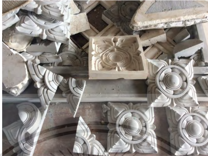
รูปที่ 1.4 ชิ้นงานประจายามหล่อโดยแบบหล่อซิลิโคน โบสถ์วัดสวนสันติธรรม จังหวัดชลบุรี (ที่มา:ผู้วิจัย)
