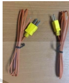
B. FLUKE 80PK-1 (K Type) 1 m (ย่านการวัด 0 - 200°C)
