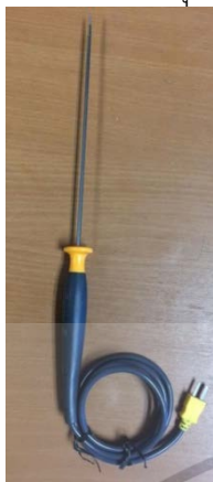
A. FLUKE 80PK-25 (304 Stainless steel) 1 m (ย่านการวัด 0 - 1500°C)
