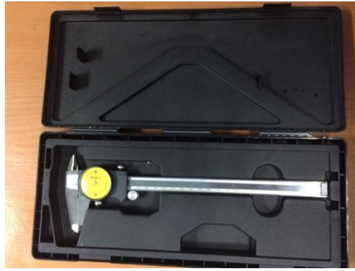
รูปที่ 3.14 Vernier Calliper (Mitutoyo)
