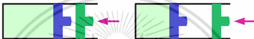
(ก) การอัดตัวอย่างช้าๆ (quasi – equilibrium) (ข) การอัดตัวอย่างเร็วๆ (nonquasi – equilibrium)
