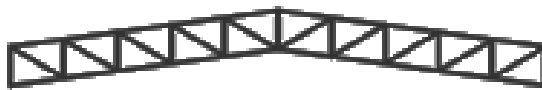
รูปที่ 2.8 แสดงรูปแบบโครงถักแบบเอียงคอร์ดขนาน
