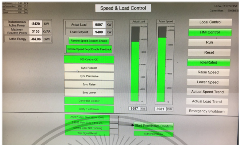
รูปที่ 2.13 การควบคุม Speed และ Load สำหรับโรงไฟฟ้าชีวมวล
