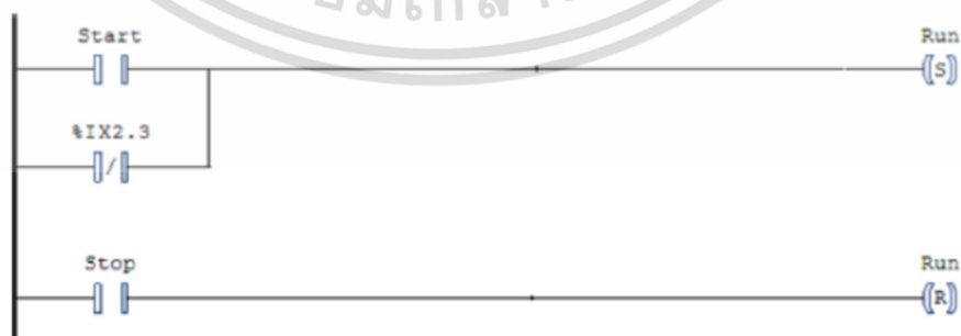
รูปที่ 3.23 ตัวอย่างภาษา Ladder Diagram - LD
