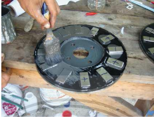
รูปที่ ก. 10 ทาสีกันสนิมที่แผ่นแม่เหล็ก
