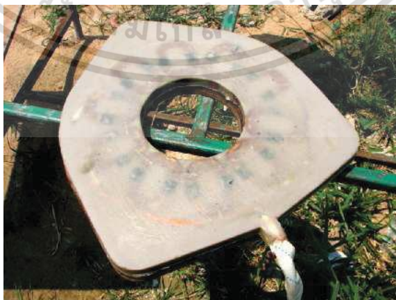
รูปที่ ก. 6 นำชุดขดลวดที่ทำการหล่อแบบแล้วไปทิ้งไว้ให้แห้งสนิท
