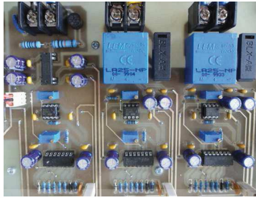
รูปที่ ค.4 การลงอุปกรณ์จริงของวงจรตรวจจับกระแสและแรงดัน
