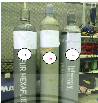
รูปที่ 3.15 ชนิดของฉนวนก๊าซสำหรับการทดสอบ และถังบรรจุก๊าซทิ้งหลังทดสอบ 1.ก๊าซ SF 6 2.ถังบรรจุก๊าซทิ้ง 3.ก๊าซ N 2
