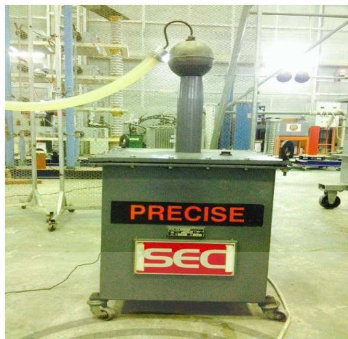
รูปที่ 3.17 หม้อแปลงทดสอบแรงดันสูง 235/100 kV, 5 kVA
