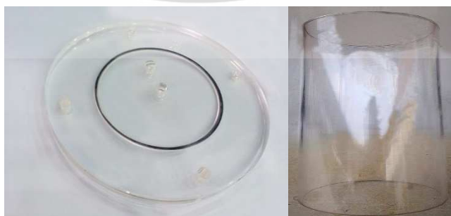
รูปที่ 3.2 ที่บรรจุฉนวนก๊าซและใส่ไอเล็กโตรดของชุดทดสอบคุณสมบัติของก๊าซ SF 6 , N 2 , และอากาศ ที่ได้ออกแบบสร้างจริง
