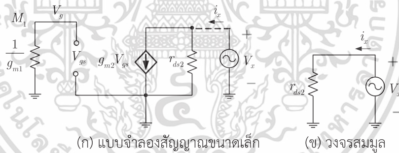
รูปที่ 2.5 แบบจำลองสัญญาณขนาดเล็กและวงจรสมมูลของวงจรสะท้อนกระแส
