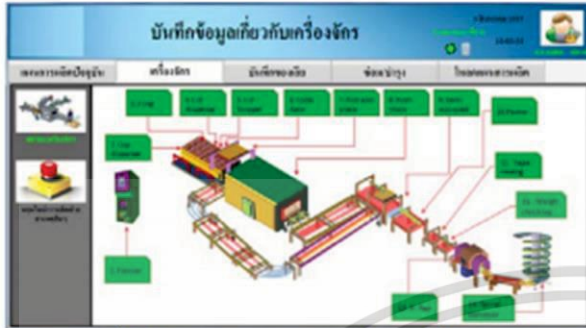
รูปที่ 5 โปรแกรมแสดงสถานะการทำงานของเครื่องจักร
